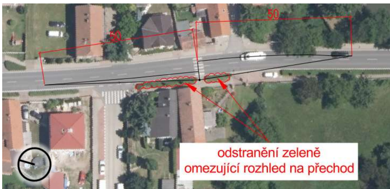
Obrázek 94 – Rozhled na přechod pro chodce u křižovatky MK K Hrnčířům x K Vrbičkám. [28]
