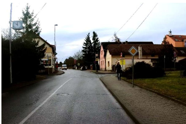
Obrázek 168 – Absence SDZ B 24a v místě stykové křižovatky MK K Šeberovu a Zadní.
