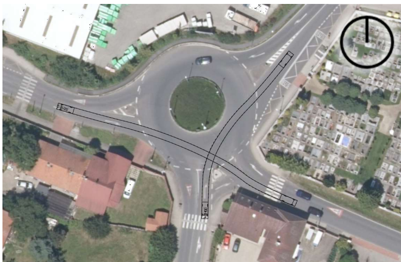
Obrázek 75 – Schematické znázornění tangenciálních průjezdů okružní křižovatkou. [28]
