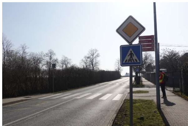
Obrázek 153 – Riziková kombinace SDZ P 2 a IP 6 v MK K Šeberovu.
